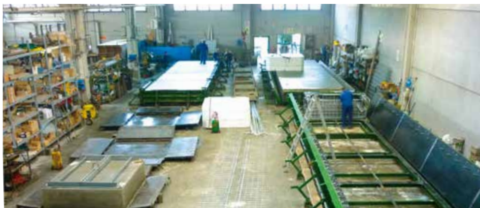
Reparto produzione galleggianti in cemento armato
